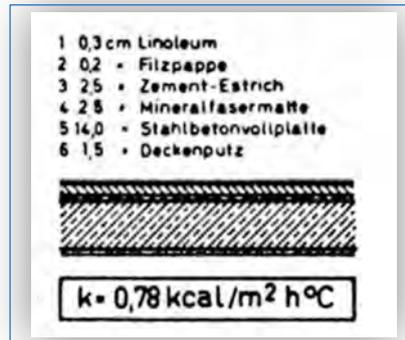
Abb. 103: BMBau Schriftenreihe 1978 Dachböden aus Modellbauvorhaben  $0,91 \text{ W}/(\text{m}^2\text{K})$
